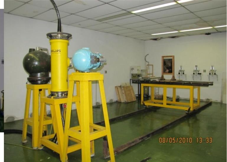
Os raios X que atravessam o objeto são capturados atrás do objeto por um detector (um filme sensível ou um detector digital), que fornece uma imagem em duas dimensões (2D) revelando informações tanto da superfície quanto do interior do objeto.
