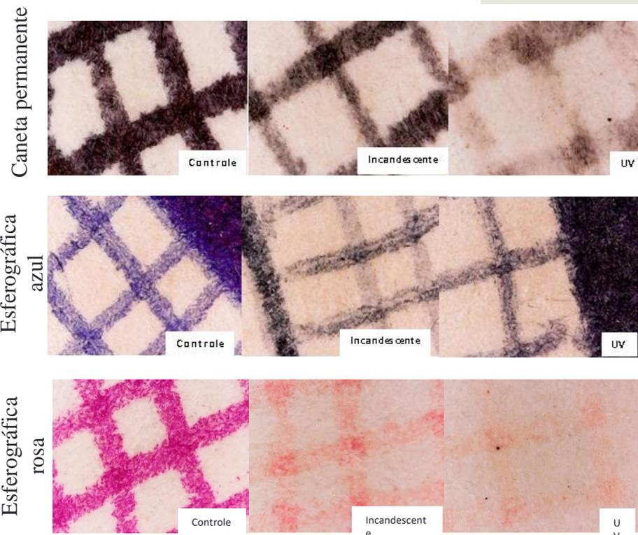
Microscopias de amostras utilizadas na degradação depois de 60 dias
