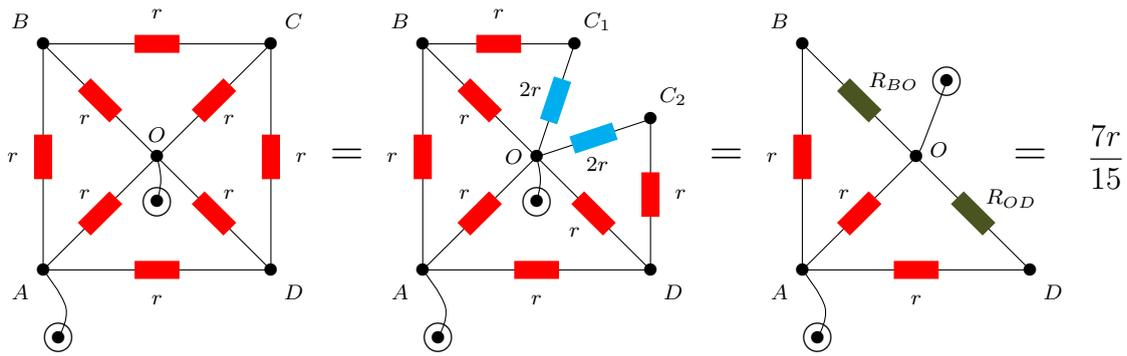
**Fig 10.** Figura para o Exemplo 7. Sequência de transformações do circuito.
