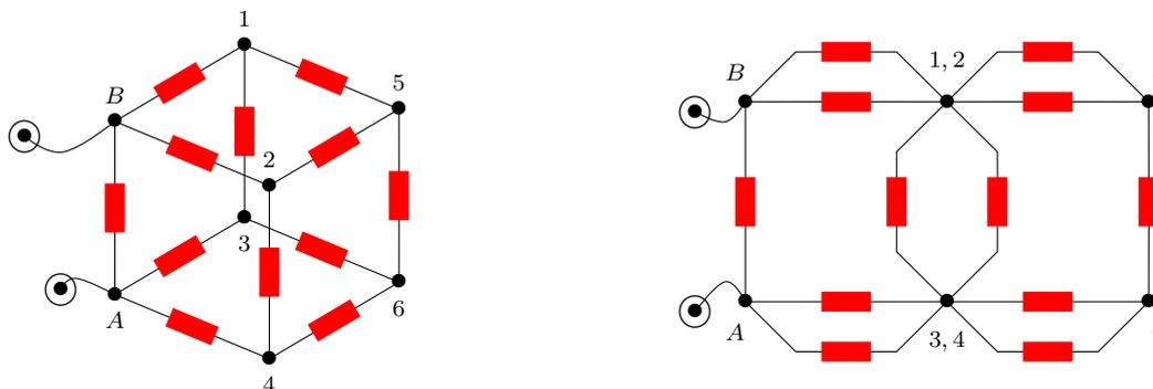
**Fig 4.** Circuito para o exemplo 2: esquerda conexão cúbica de resistências, direita representação plana equivalente ao cubo de resistências. Cada resistor vermelho é de valor  $r$ .
