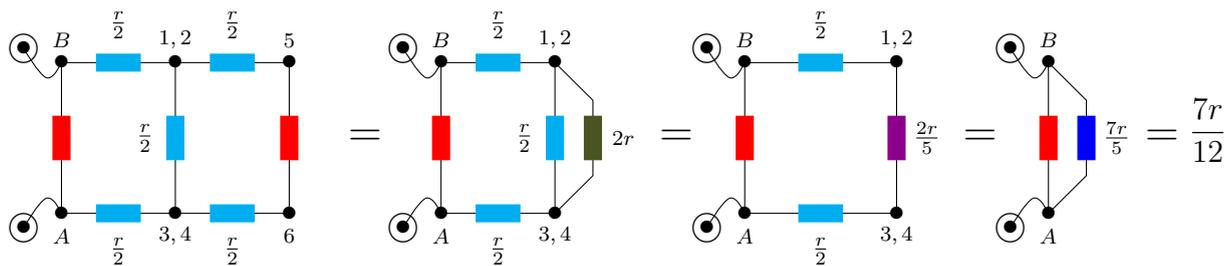
**Fig 5.** Transformações de equivalência que são realizadas sucessivamente no circuito da Fig 4-direita até chegar num valor de resistência equivalente
