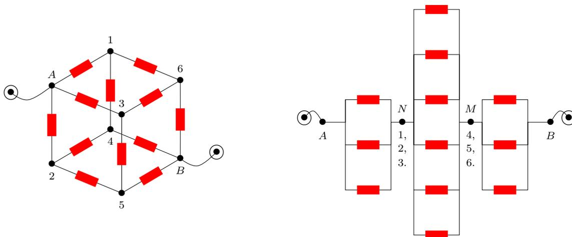
**Fig 3.** Circuito para o exemplo 1: esquerda conexão cúbica de resistências, direita representação plana equivalente ao cubo de resistências. Cada resistor vermelho é de valor  $r$ .
