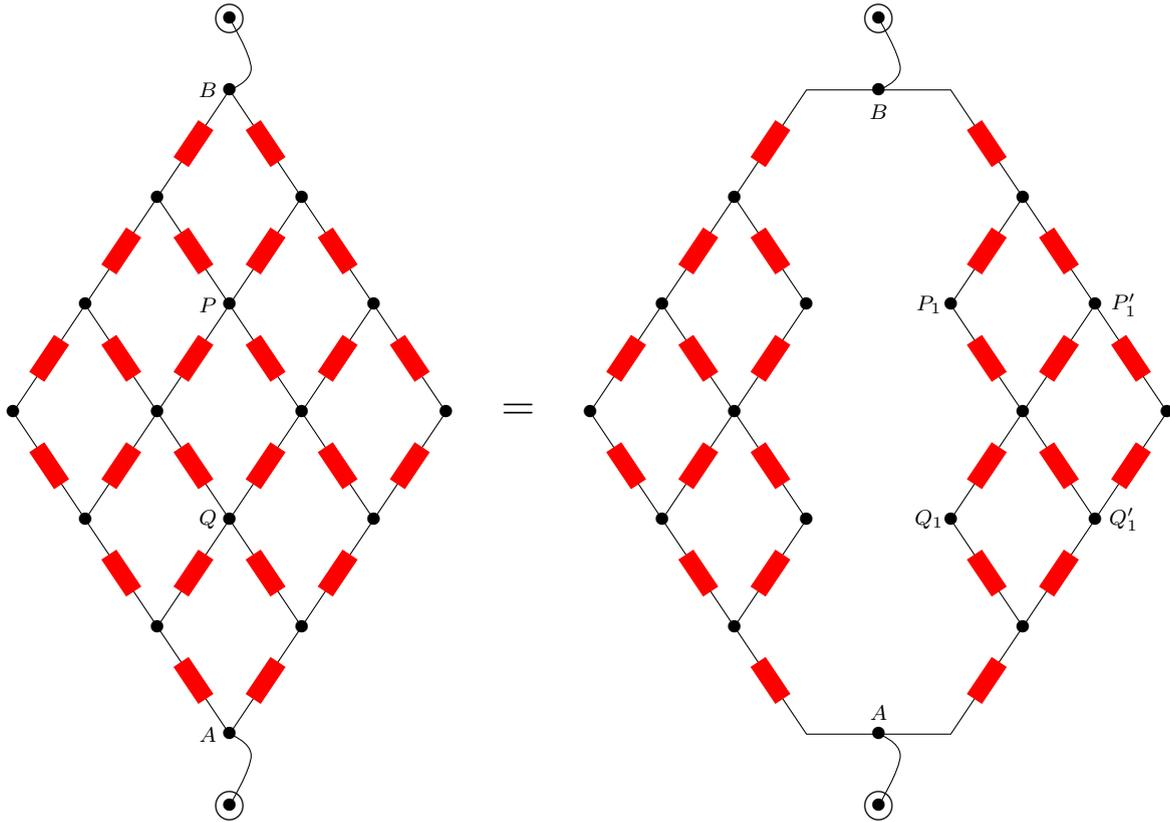
**Fig 9.** Circuito para o exemplo 6. Decomposição do circuito complexo original em dois ramos não tão complexos conectados em paralelo.
