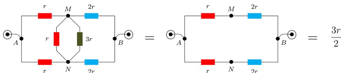
**Fig 6.** Circuito para o exemplo 3. Transformações equivalentes (exclusão do ramo  $M-N$ ).
