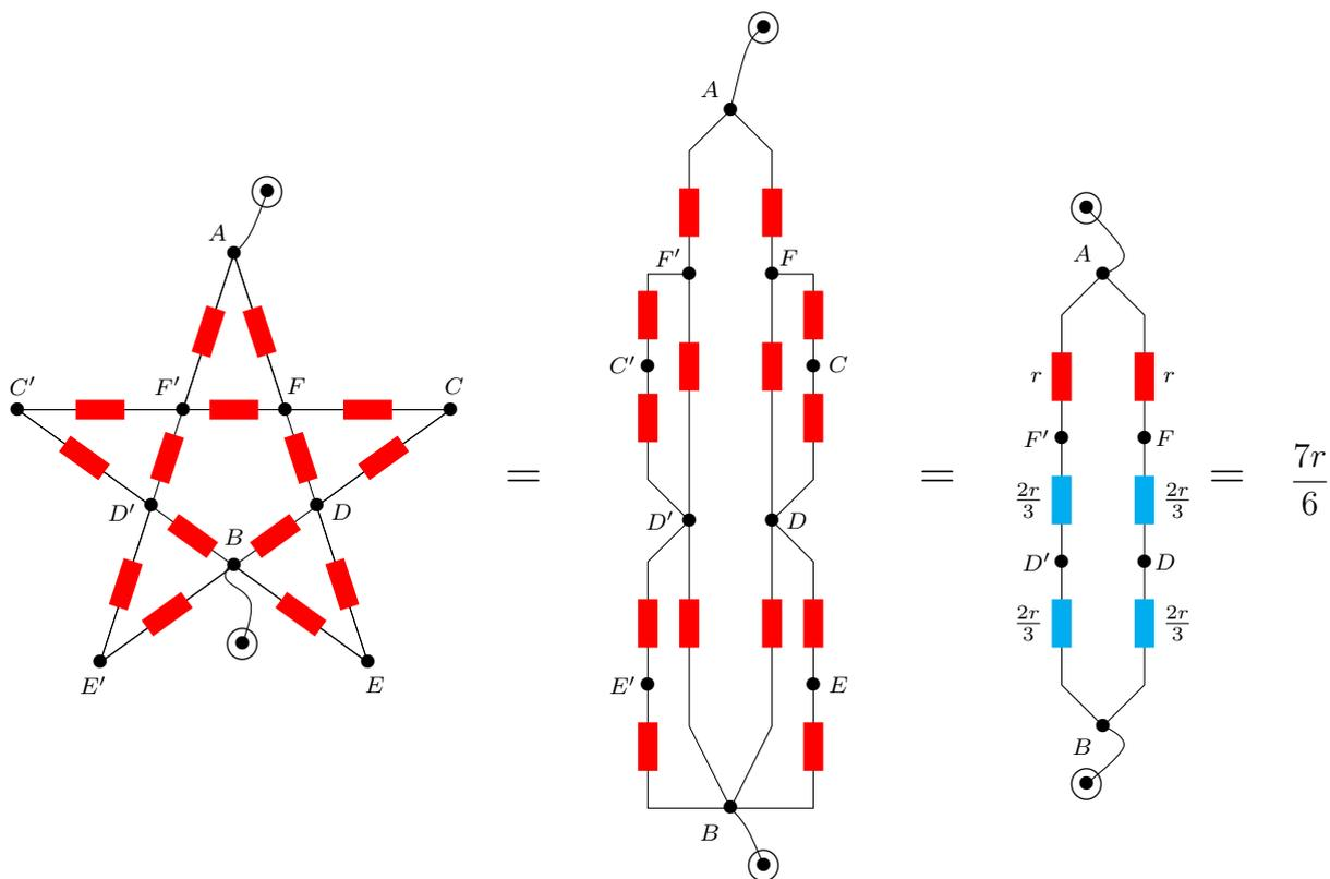
Fig 7. Circuito em estrela para o exemplo 4. Conjunto de transformações equivalentes.
