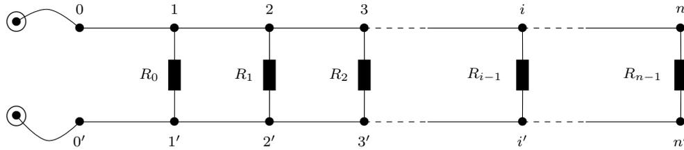
**Fig 2.** Conexão em paralelo de um conjunto  $\{R_0, R_1, R_2, \dots, R_{n-1}\}$  de  $n$  resistores.
