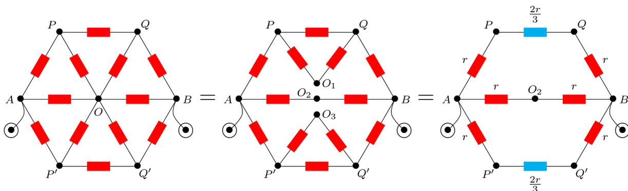
Fig 8. Circuito hexagonal para o exemplo 5. Conjunto de transformações sucessivas.
