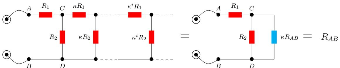
**Fig 11.** Circuito infinito e o circuito finito equivalente para o exemplo 8.
