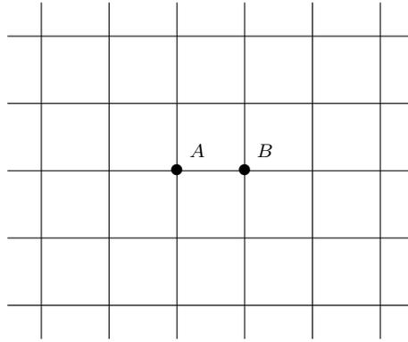
**Fig 13.** Rede resistiva infinita.
